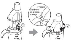
7. Montare correttamente la maschera, il boccaglio o la forcella nasale sull'ampolla nebulizzatrice.
