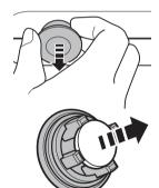
2. Sostituire il filtro dell'aria.
